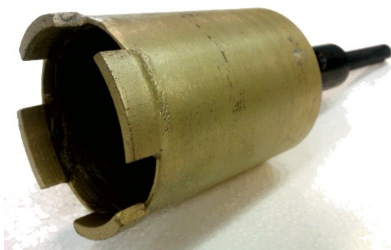
Wiertło koronowe wg. wynalazku po wykonaniu 950 odwiertów
