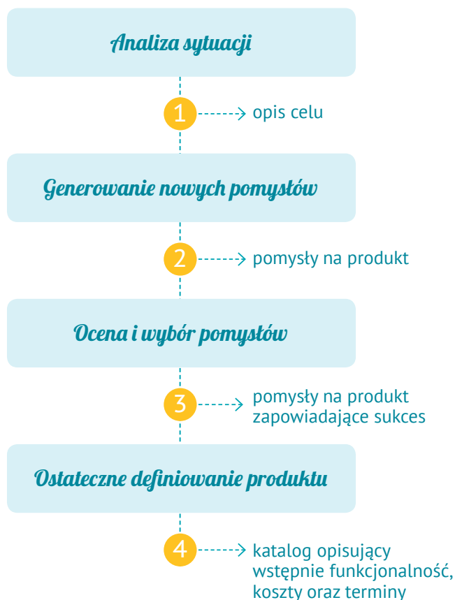
Rys. 2. Schemat powstawania nowego produktu
