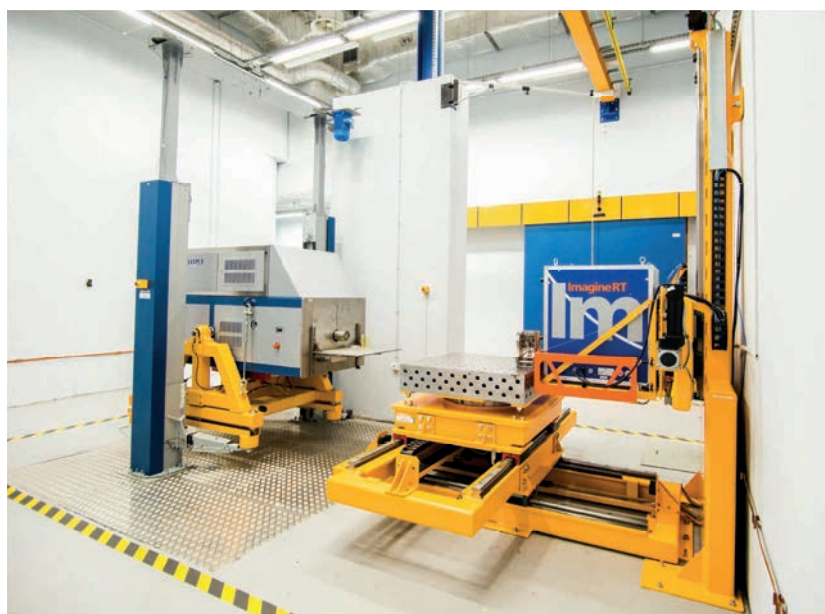
LBN – Stanowisko badawcze wielkogabarytowej radiografii przemysłowej z zastosowaniem dwufunkcyjnego akceleratora elektronów
